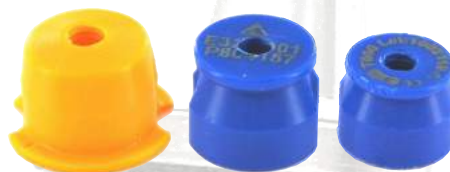
Cupules d'essai : jaune sans ciment, bleu cimenté grande taille, bleu cimenté petite taille
